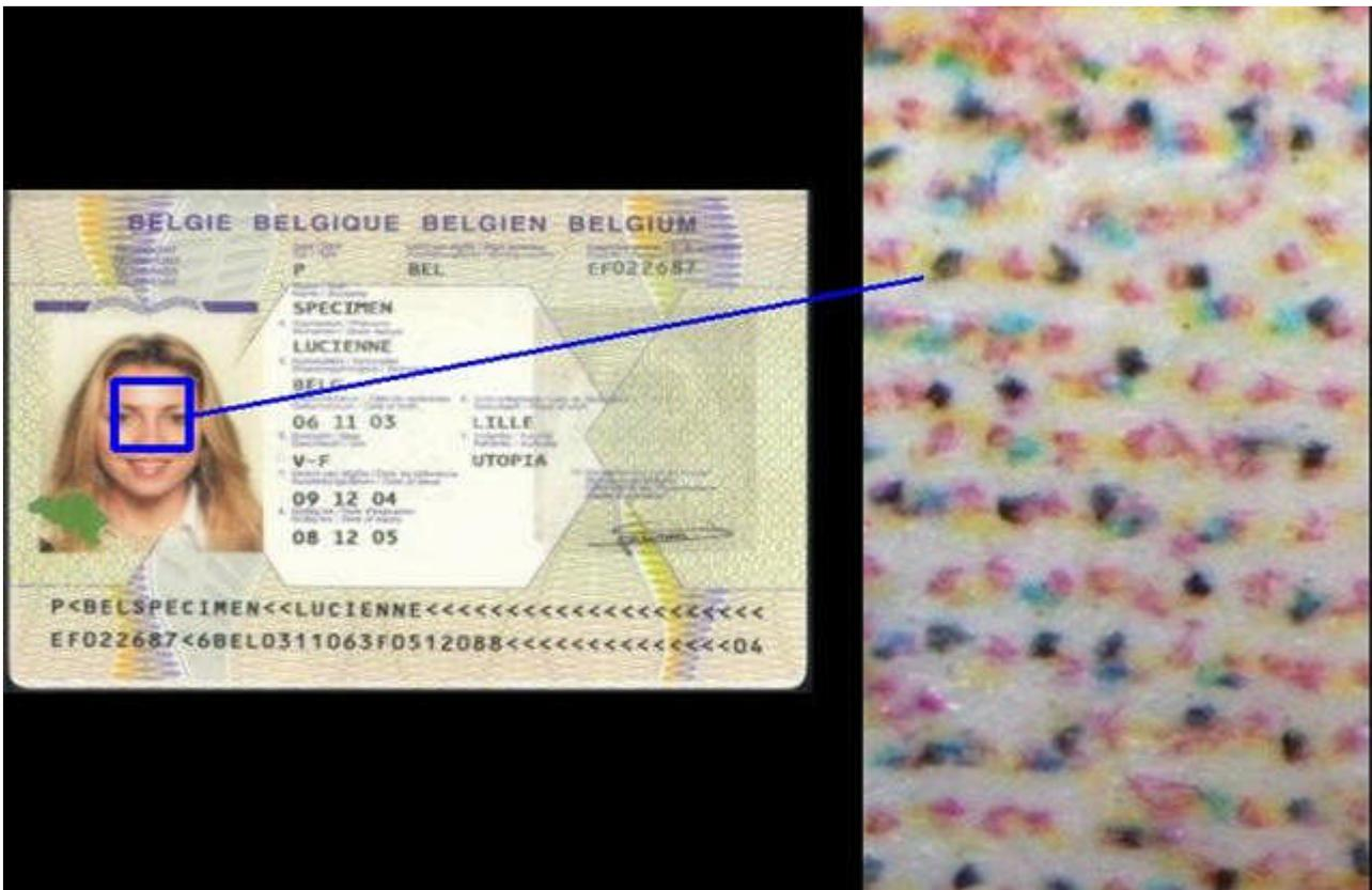
Belgien: Integration der Personaldaten und des Lichtbildes mittels Tintenstrahldruckverfahrens
