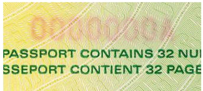
Druckfarbe für die Seriennummer ist teilweise durch den Bedruckstoff durchgeblutet und auf der Rückseite sichtbar.
