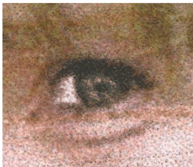
Deutschland: einheitliches Visumformat der EU – Integration der Personaldaten / des Lichtbildes mit dem Tintenstrahlverfahren
