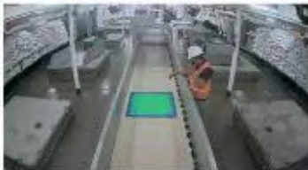
Kuva 1. A) Esimerkki kurenuotta-alukseen asennetusta kuusi kameraa käsittävästä sähköisestä seurantajärjestelmästä, joka kattaa pääasialliset kalastus- ja kalankäsittelyalueet (teoksesta Murua et al., 2020b) ja B) kurenuotta-alukseen asennetusta seitsemän kameraa käsittävästä sähköisestä seurantajärjestelmästä (neljä kameraa yläkannella ja kolme välikannella), joka kattaa pääasialliset kalastus- ja kalankäsittelyalueet, mukaan lukien vielä yksi kamera kuljetushihnan luona: (B1) 360° panoraamakamera (esim. näkymä paapuurin puolesta), (B2) märssykorin peräkamera, (B3) työkanne nosturin kamera, (B4) etukanne kamera, (B5) kuljetushihnan peräkamera, (B6) kuljetushihnan keskilaivakamera ja (B7) kuljetushihnan keulakamera (lähde: Digital Observer Services).
