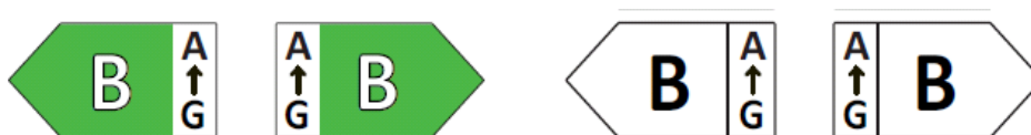
Rysunek 1. Przykład kolorowej i monochromatycznej strzałki skierowanej w lewo/prawo z podanym zakresem klas efektywności energetycznej
