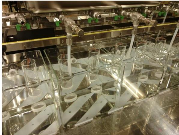
Esta incubadora consta de un cuerpo cilíndrico de vidrio (de 5 cm de diámetro y 10 cm de altura) y de malla de alambre inoxidable (0,25  $\phi$  y 32 mallas) que está fijada a la parte inferior del cuerpo con un anillo de PTFE. Se suspenden las incubadoras de la barra de elevación en los recipientes y se agitan verticalmente (aproximadamente 5 cm de amplitud) en un ciclo adecuado (aproximadamente una vez cada 4 segundos) en el caso de los huevos de medaka.
