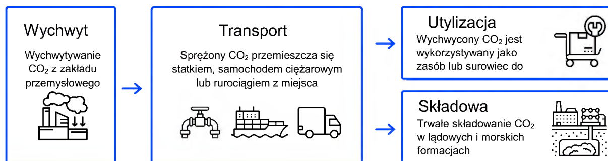
Rysunek 21: System wychwytywania, utylizacji i składowania dwutlenku węgla
