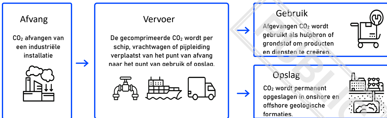
Figuur 21: regeling voor koolstofafvang, -gebruik en -opslag
