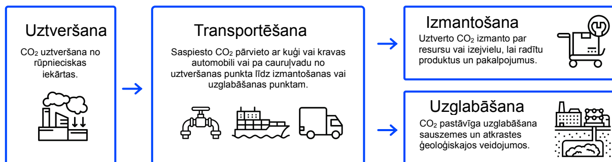
21. attēls. Oglekļa uztveršanas, izmantošanas un uzglabāšanas shēma
