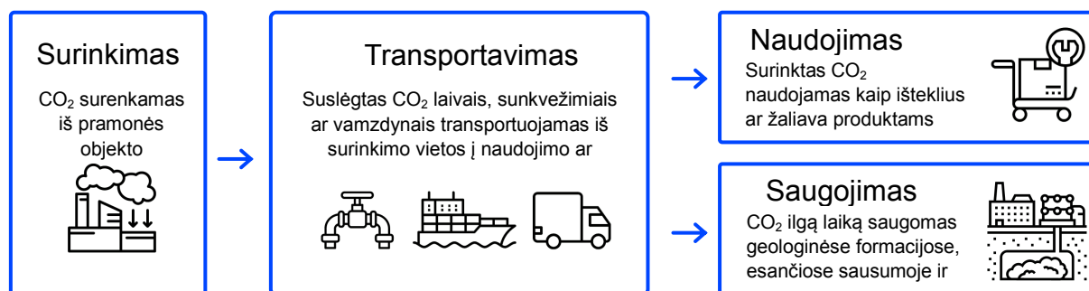
21 pav. Anglies dioksido surinkimo, naudojimo ir saugojimo schema
