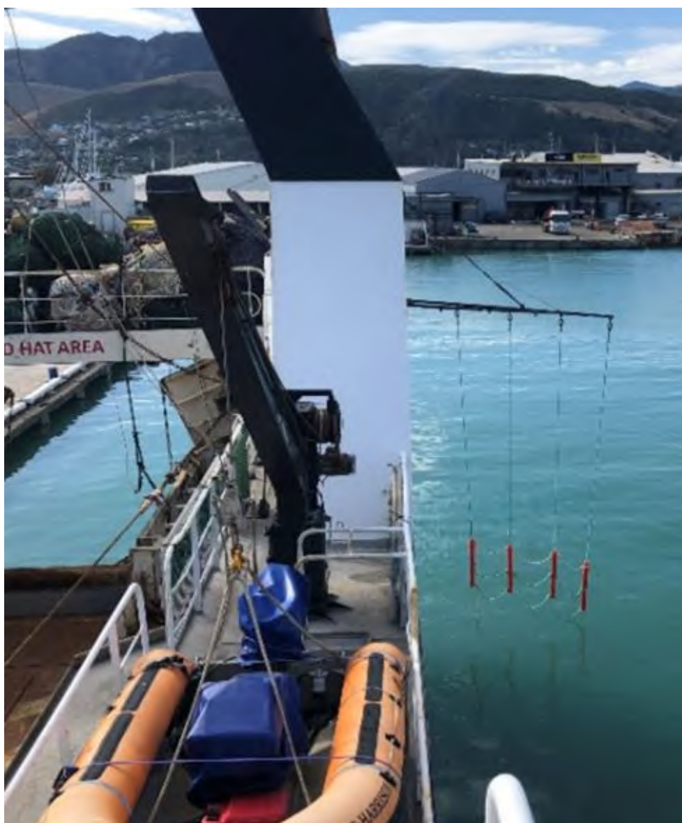
Figur 1: Bird baffler används. Havsfåglar hindras från att flyga runt fartygets akter.
