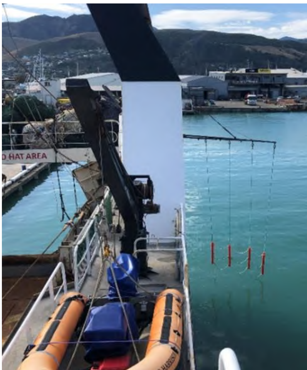
Slika 1: nameščena naprava za odganjanje ptic. Morskim pticam se prepreči letenje okoli krme plovila.
