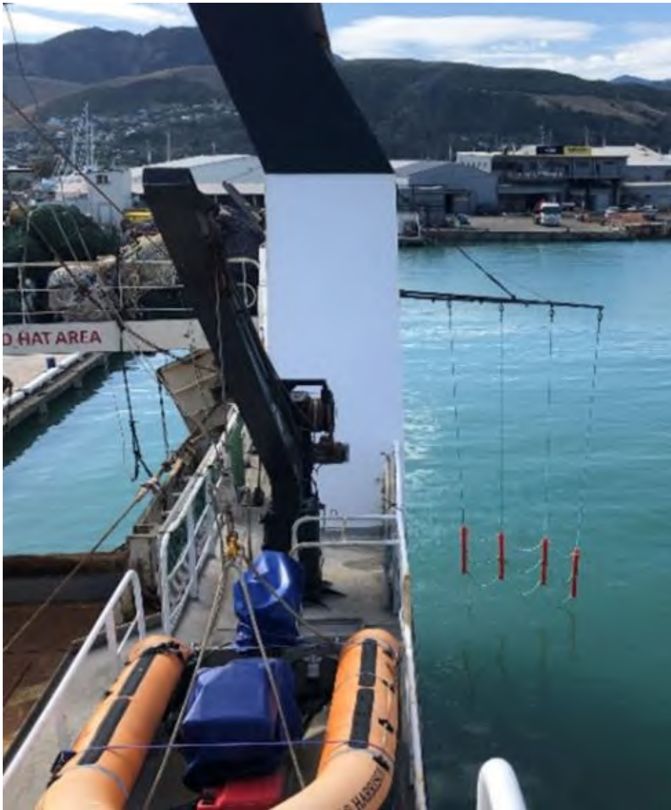
Abbildung 1: Vogelabwehrvorrichtung. Seevögel werden daran gehindert, um das Heck des Schiffes zu fliegen.
