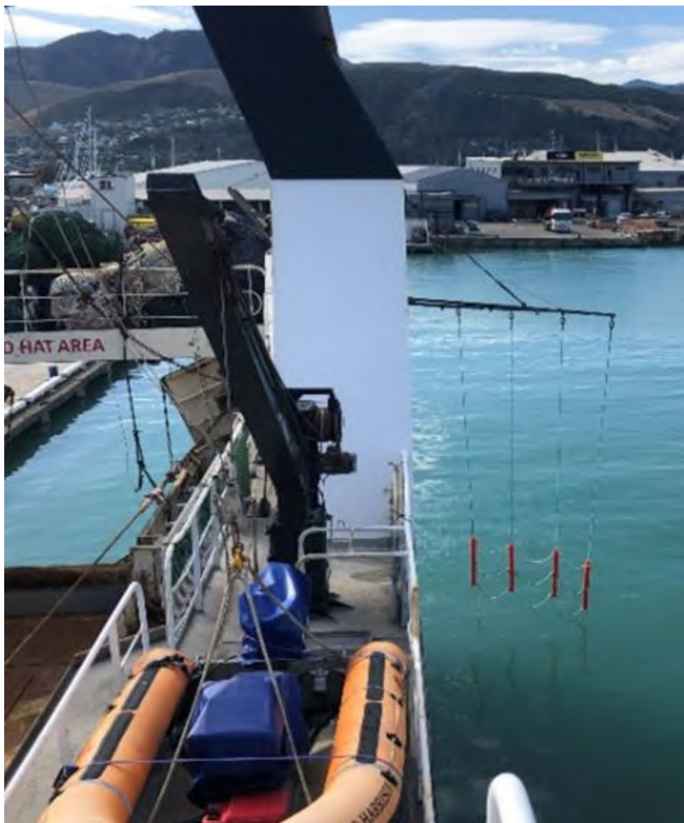
Obrázek 1: Instalované zařízení pro odrazování ptáků. Mořským ptákům je znemožněno oblétnout zád' plavidla.
