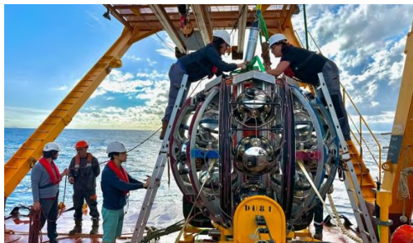
A KM3NeT egy mélytengeri teleszkóp, amely a Földközi-tengerben, 3,5 km-es mélységben található. A tenger vizében felfüggesztett optikai szenzorokat használ a nagy energiájú kozmikus neutrínók kimutatására. 2023-ban észlelte a valaha mért legnagyobb energiájú neutrínót, ami mérőföldkő a fundamentális fizikában.
