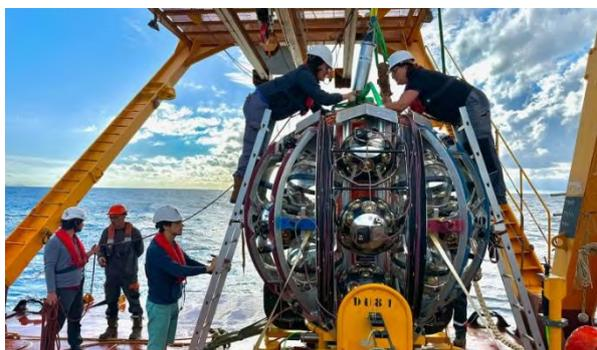
O KM3Net é um telescópio subaquático instalado no mar Mediterrâneo a uma profundidade de 3,5 km. Utiliza matrizes de sensores óticos suspensos na água do mar para detetar neutrinos cósmicos de alta energia. Em 2023, detetou o neutrino mais energético alguma vez registado, um marco para a física fundamental.
