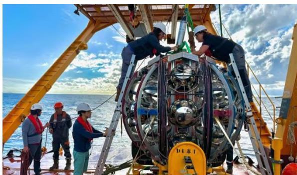
KM3NeT est un télescope sous-marin situé en mer Méditerranée à une profondeur de 3,5 km. Il utilise des réseaux de capteurs optiques immergés dans l'eau de mer pour détecter des neutrinos cosmiques de haute énergie. En 2023, il a détecté le neutrino le plus énergétique jamais enregistré, une étape importante pour la physique fondamentale.
