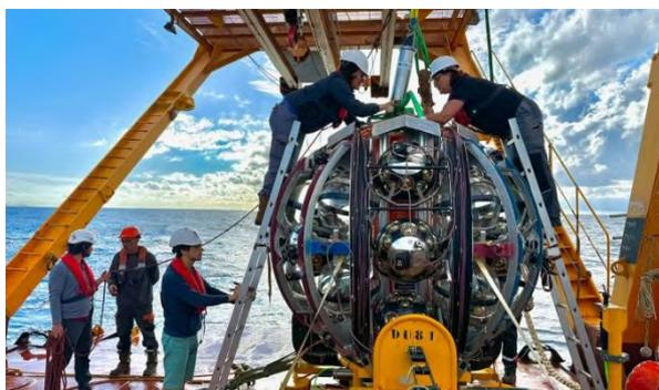
KM3Net es un telescopio de aguas profundas situado a 3,5 km por debajo del mar Mediterráneo. Utiliza conjuntos de sensores ópticos suspendidos en agua de mar para detectar neutrinos cósmicos de alta energía. En 2023, detectó el neutrino más energético jamás registrado, un hito para la física fundamental.
