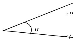
pri čemu je  $\alpha$  kut koji je izmjerен iz vodoravnog položaja prednje strane uređaja (okrenute prema gore) i u kojem je položaju uređaj kalibriran, a kutovi  $\beta$  i  $\gamma$  prikazuju najveći dopušten otklon prema gore, odnosno, prema dolje od kuta  $\alpha$ .
