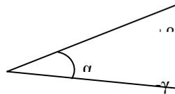
wobei  $\alpha$  der von der waagerechten Stellung der (nach oben geneigten) Vorderseite des betreffenden Gerätes aus gemessene Winkel ist;  $\beta$  und  $\gamma$  sind die höchstzulässigen Neigungsausschläge nach oben und unten gegenüber dem Winkel " $\alpha$ ".
