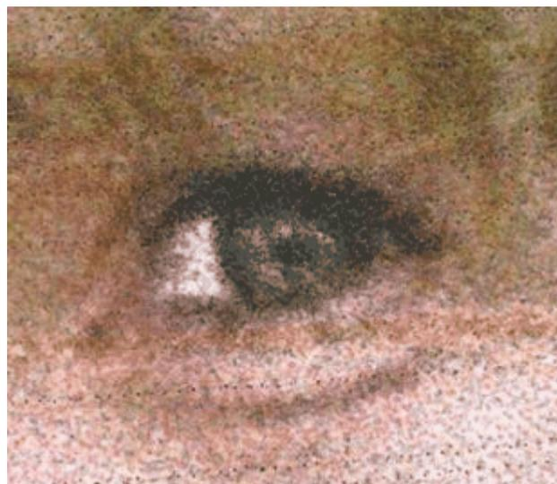
Germania: modello uniforme di visto UE - integrazione di dati anagrafici / fotografia con tecnica di stampa a getto d'inchiostro
