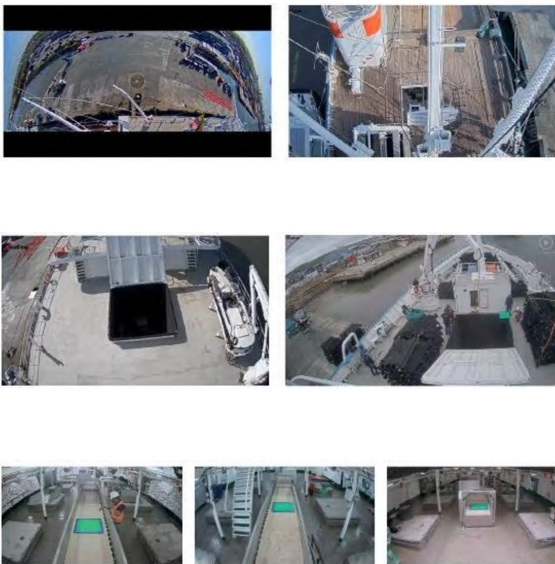
Γράφημα 1. Α) Παράδειγμα συστήματος ηλεκτρονικής παρακολούθησης με 6 κάμερες εγκατεστημένου σε σκάφος γρι-γρι, το οποίο καλύπτει τους κύριους χώρους δραστηριοτήτων αλιείας και χειρισμού ιχθύων (από Murua et al., 2020b) και Β) σύστημα ηλεκτρονικής παρακολούθησης με 7 κάμερες (4 στο άνω κατάστρωμα και 3 στο κατάστρωμα χάσματος), εγκατεστημένο σε γρι-γρι, το οποίο καλύπτει τους κύριους χώρους των δραστηριοτήτων αλιείας και χειρισμού ιχθύων και περιλαμβάνει 1 επιπλέον κάμερα στον ιμάντα μεταφοράς: Β1) κάμερα πανοραμικής θέασης 360° (π.χ. εικόνα της αριστερής πλευράς του σκάφους), Β2) κάμερα καρχησίου με θέα στην πρύμνη, Β3) κάμερα καταστρώματος εργασίας με θέα στον γερανό, Β4) κάμερα προωαίου καταστρώματος, Β5) κάμερα ιμάντα μεταφοράς με θέα στην πρύμνη, Β6) κάμερα στο μέσο του ιμάντα μεταφοράς και Β7) κάμερα ιμάντα μεταφοράς με θέα στην πλώρη (πηγή: Digital Observer Services).
