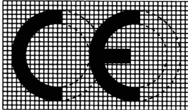
2. Bei Verkleinerung oder Vergrößerung der CE-Kennzeichnung sind die sich aus dem oben abgebildeten Raster ergebenden Proportionen einzuhalten.
